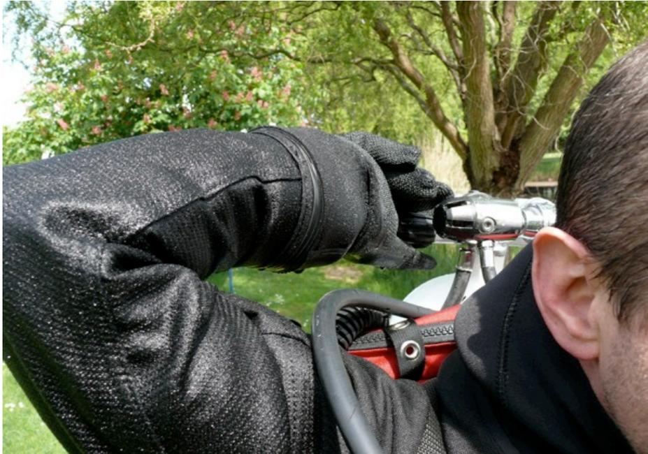
Ventile werden immer ganz aufgedreht – man spürt sofort die richtige Drehrichtung beim Schließen über Kopf!
