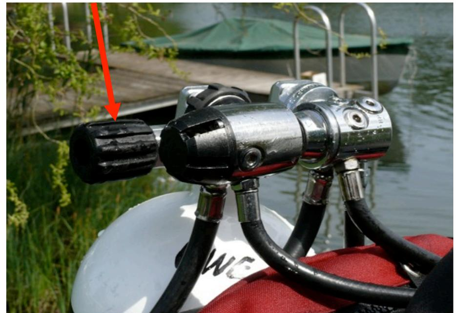
Erste Stufen werden waagrecht montiert – alle Schläuche sind nach unten gerichtet.
